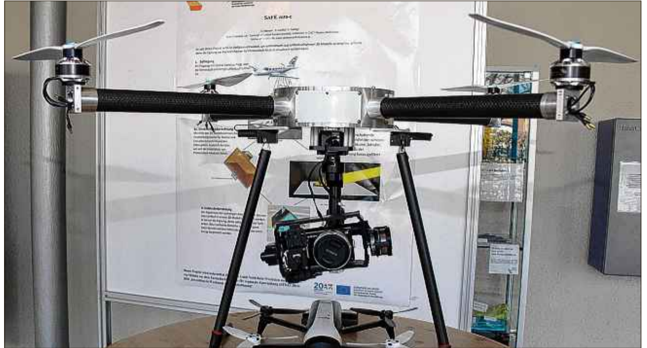
Drohnen bringen Wärmebildkameras in Position und stellen so fest, welche Stellen an einem Haus sanierungsbedürftig sind. Fotos: pr
